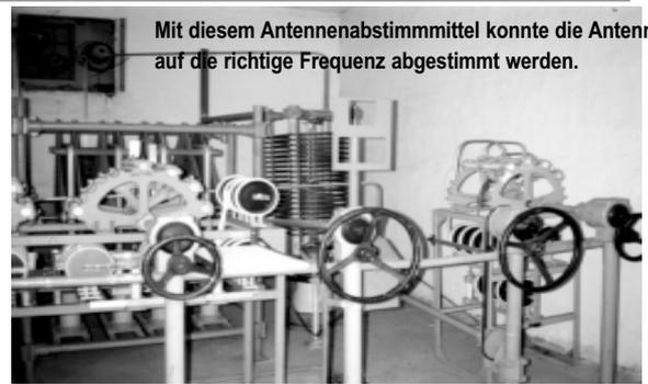
Mit diesem Antennenabstimmittel konnte die Antenne auf die richtige Frequenz abgestimmt werden.
